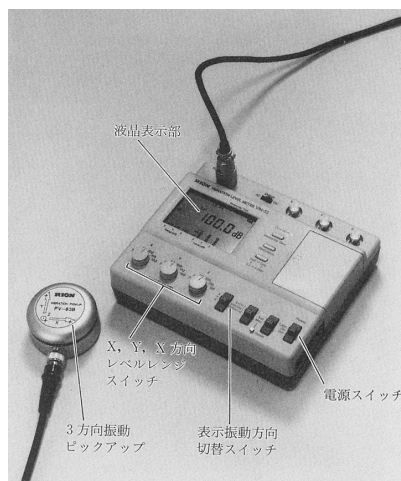
図 振動レベル計と振動ピックアップ(出典: 参考文献[1], p.152)
