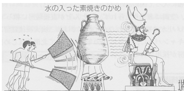
図 古代エジプトの蒸発冷却法（参考文献 [1]，p. 74）
