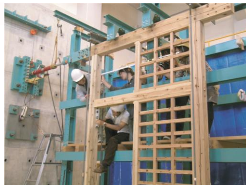
写真1 構造実験棟での格子壁強度実験風景
